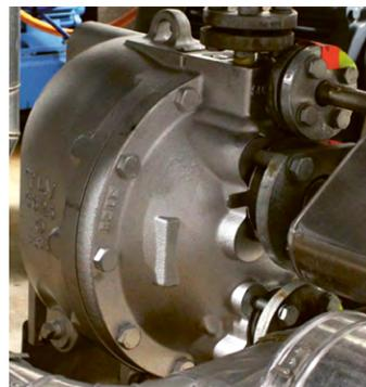
Clapet anti-retour avec la languette de côté.
